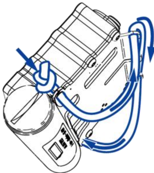
Fig 2 - Installazione del cavo da polso
