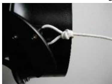
Fig 13 - Fissaggio della fune al lato sinistro
